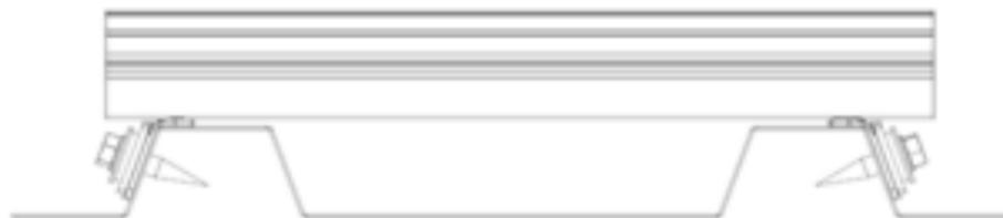
**Alternative** : fixation sur la charpente au travers de la couverture bacs acier
